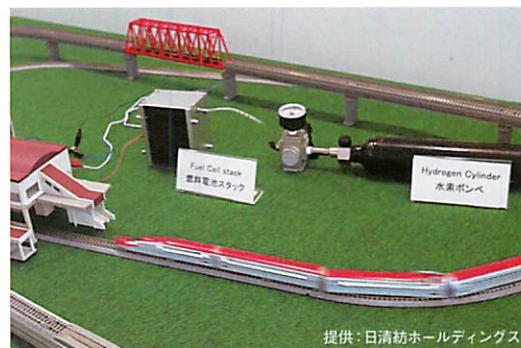
提供：日清紡ホールディングス 日清紡HDはカーボンアロイ触媒を使った燃料電池で走る模型電車を公開している。ここで使われている燃料電池の出力は約10W。
