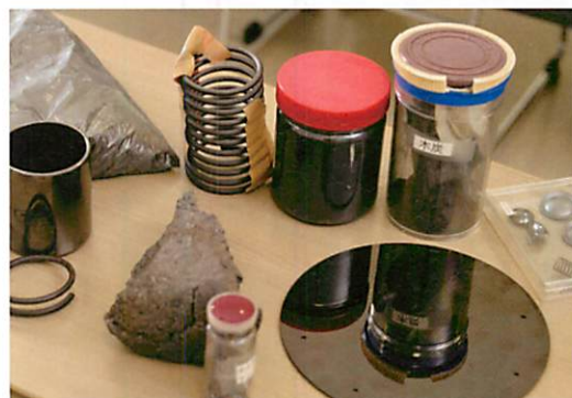
写真上はカーボンの構造モデル。中央がグラファイト、右はダイヤモンド、左はフラーレン（炭素原子からなるクラスターの総称）。写真下は研究室にある多彩なカーボンの数々。試作のスプリングは恐ろしく軽量だが「実は引っ張りには弱い」（尾崎教授）とも。
